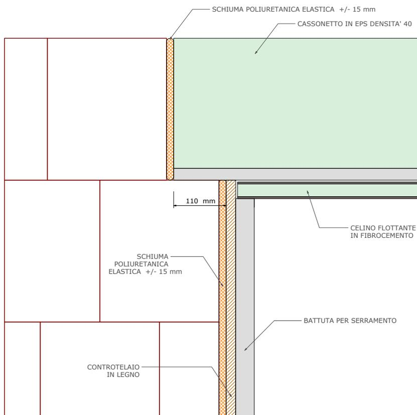
MONTAGGIO INFISSO A FILO MURO INTERNO / RACCORDO CASSONETTO PILASTRO
